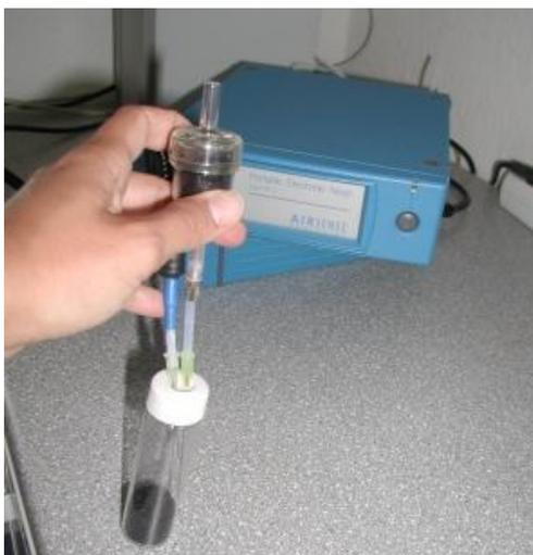
Abbildung 10: Kalibrierung der elektron. Nase mit Ethyl-Acetat
